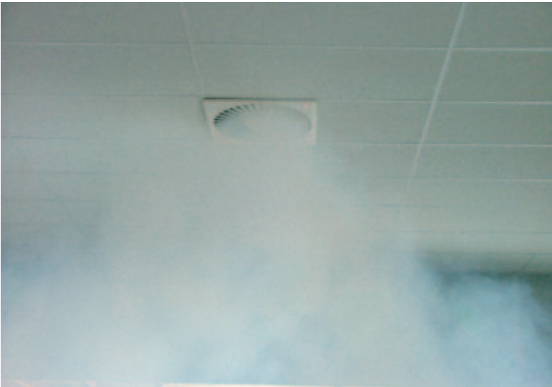
Slika 5. Istrujavanje iz stropnog difuzora bez prisutnosti "Coanda efekta"
